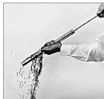
Gefangene Eisenteile werden durch Abstreifen entfernt
